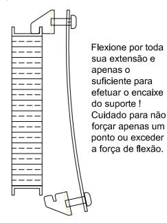
4 - Com a grade flexionada encaixe os fixadores na aba do radiador.
