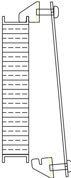
3 - Flexione a grade de radiador ao ponto de ter espaço para os fixadores inferiores passarem.
