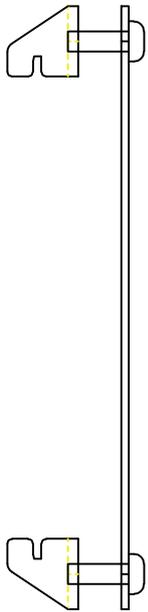
2 - Coloque os fixadores na parte superior do radiador e centralize a proteção no radiador.
