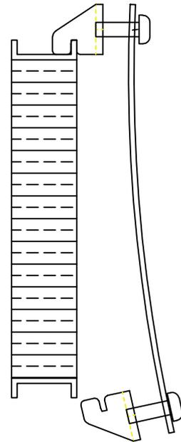
Flexione por toda sua extensão e apenas o suficiente para efetuar o encaixe do suporte ! Cuidado para não forçar apenas um ponto ou exceder a força de flexão.
