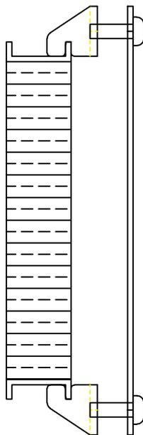
6 - Com a grade encaixada, reta e centralizada, faça o aperto dos parafusos.
